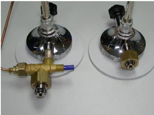
Fig. 3 Burner models with «Loose» connection
