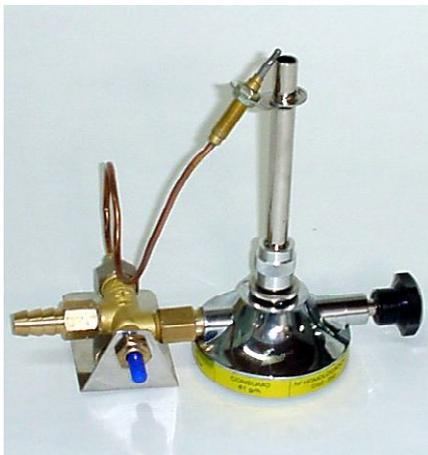
Fig B. Pulsador de la válvula corta-gas
