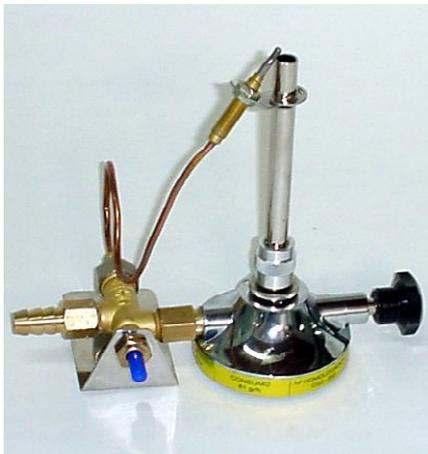
Fig B. Pulsador de la válvula corta-gas
