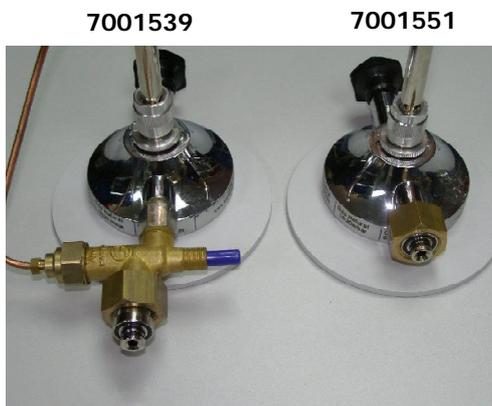
Fig. 3 Modelos de mechero con la conexión «Suelta». (Usar conexión 1001541)
