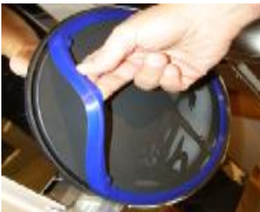
Fig. 7.3 Cambio de la junta.
