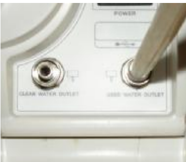
Fig 4.3 Vaciado depósito agua sucia
