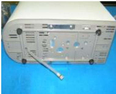
Fig. 7.2 Vaciado del depósito de agua
