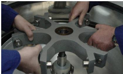
Colocar en el eje el cabezal oscilante procurando que estén perfectamente alineadas las chavetas y sus alojamientos y que el cabezal entre perpendicular en el eje. El cabezal tiene que entrar de forma suave, **no es necesario el uso de mazas ni martillos**.
