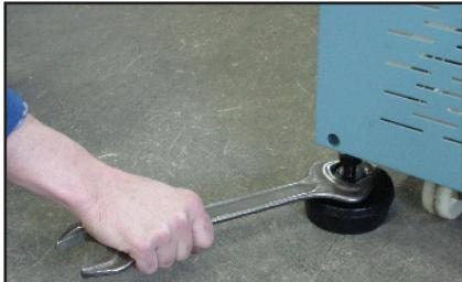
Mediante los 4 topes de goma, ajustar de forma que quede la máquina levantada de las ruedas y nivelada.
