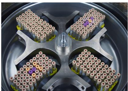
Vigilar periódicamente el estado del cabezal y sus vasos a fin de poder detectar posibles indicios de corrosión, grietas, fisuras o de deformaciones mecánicas.
