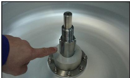
Antes de colocar el cabezal oscilante, comprobar que las chavetas de arrastre estén debidamente alojadas.
