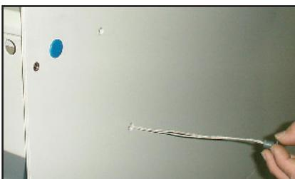
Abrir la puerta de la máquina tirando de los cables.
