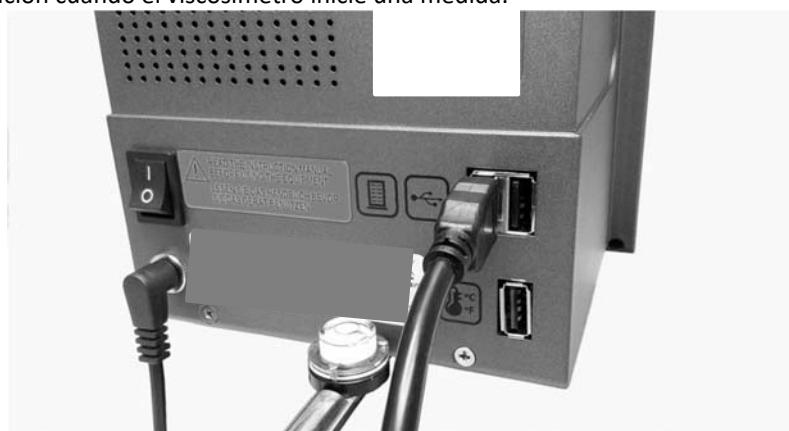
Fig. 18 Conexión unidad termostática
