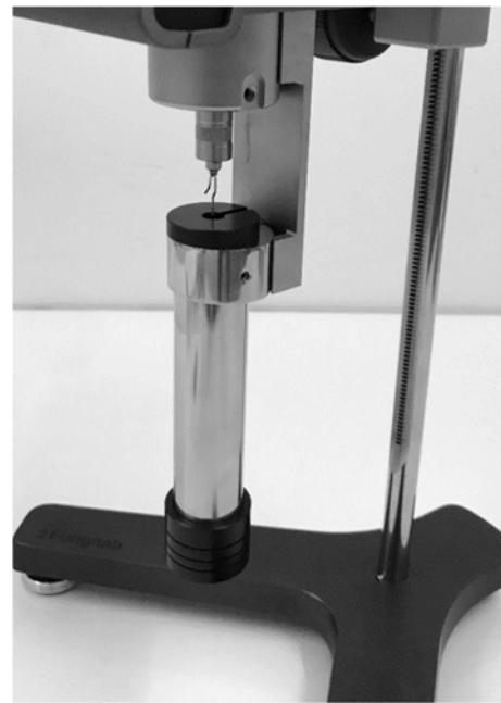
Fig.8: LCP Adaptador montado en viscosímetro
