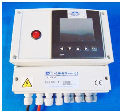
El equipo está formado por un exterior mural en ABS IP65 con caja de conexiones y salida de cables a proceso en la parte inferior. También dispone de una salida USB en el lateral izquierdo.
