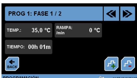
Fig. 8.4.1 Modificar los parámetros de temperatura rampa y tiempo.
