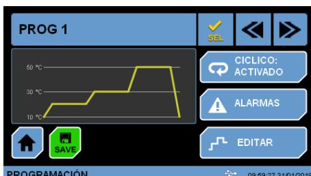
Fig. 8.4 Edición de los perfiles de temperatura
