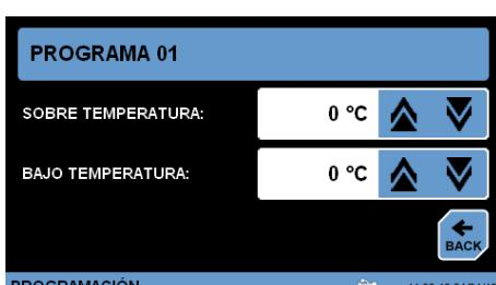
Fig. 8.4.2 Modificar los límites de temperatura máximos y mínimos.
