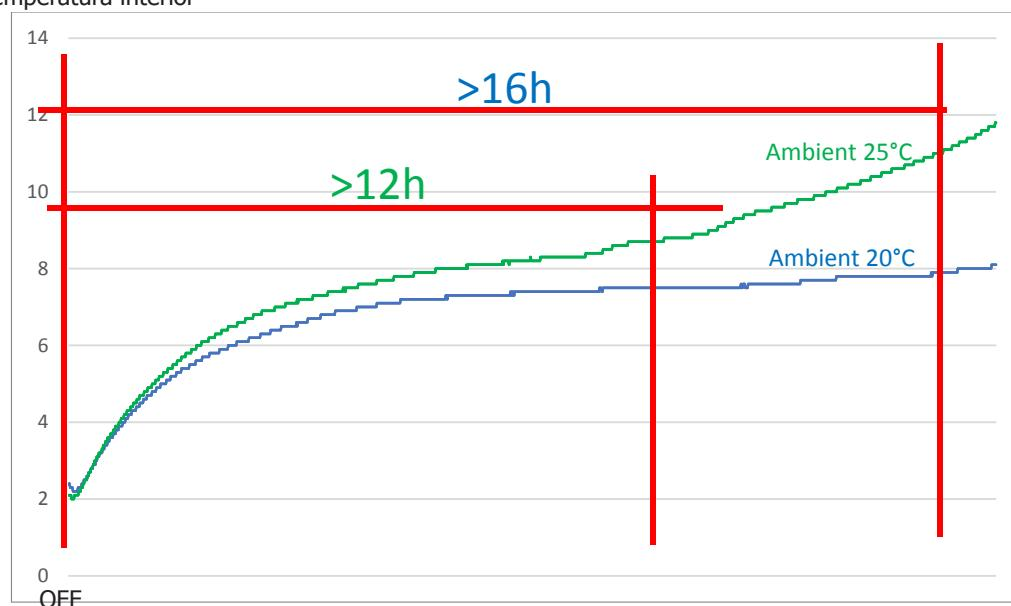
Ejemplo de la evolución de la temperatura a dos condiciones ambiente distintas desde que se produce el fallo de alimentación (OFF).
